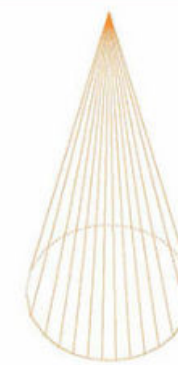
Pirámide de 20 lados Lado de la base = 0.6 cm Altura de la pirámide = 10 cm
